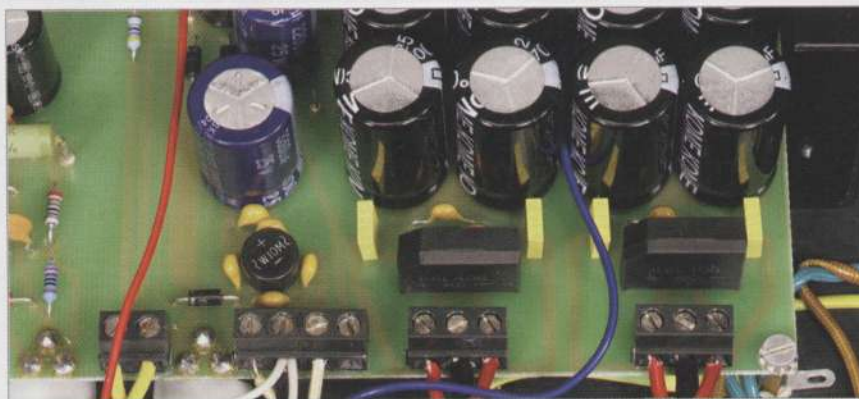
Die Mehrfach-Netzteile – hier unten im Bild beispielsweise drei Gleichrichter – sind mit erklecklichen Siebkapazitäten ausgestattet
