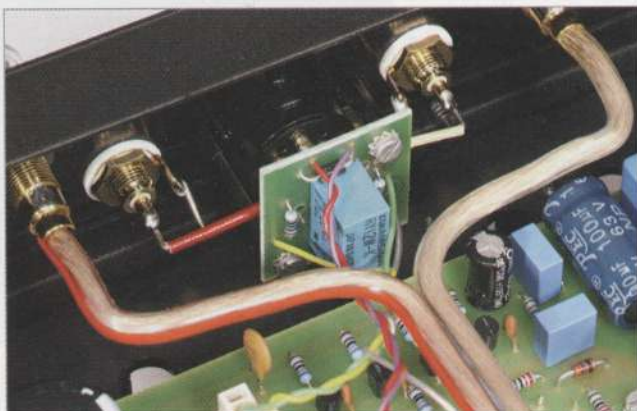
Dicke Kabel führen an die Lautsprecherklemmen. Das Relais hinter dem Eingangstrakt beeinträchtigt nicht den Signalweg
