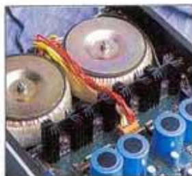
Deux transformateurs toriques de 330 VA chacun pour l'alimentation.
