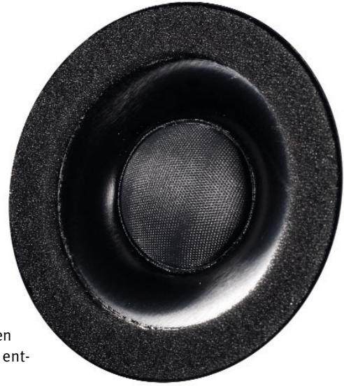
Kon-genial: Die Avanti setzt im Hochton auf einen Konus mit einer keramikbeschichteten Alu-Membran. Die Kalotte in der Mitte dient lediglich als Staubschutz.
