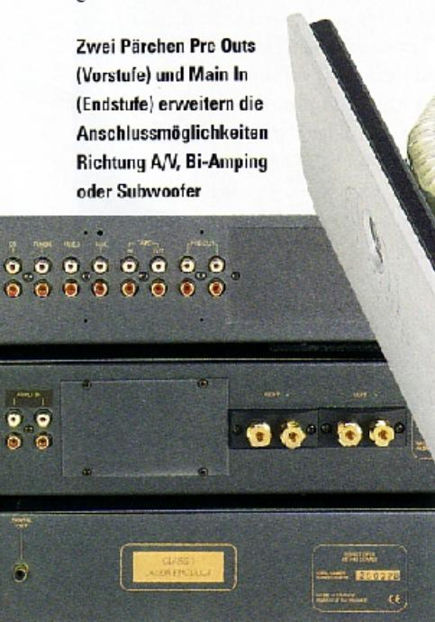
Zwei Pärchen Pro Outs (Vorstufe) und Main In (Endstufe) erweitern die Anschlussmöglichkeiten Richtung A/V, Bi-Amping oder Subwoofer
