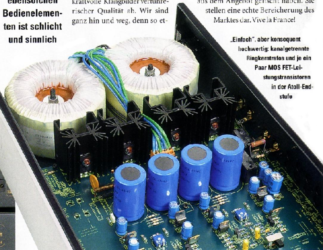
„Einfach“, aber konsequent hochwertig: kanalgetrennte Ringkerntrafos und je ein Paar MOS FET-Leistungstransistoren in der Atoll-Endstufe
