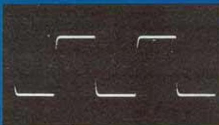
Forme du signal carré à 15 kHz/30 W. Résultats : temps de montée sur signal carré à 10 kHz rapide, soit 1,8  $\mu$ s, sans trace de dépassement ou d'instabilité.
