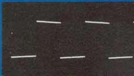
Forme du signal carré à 40 Hz/30 W. Résultats : La réponse est parfaite et on ne constate aucune atténuation du registre grave, ni inclinaison marquée des paliers, même à 20 Hz.
